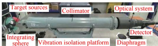
图 11 实验室平场定标实验装置图
