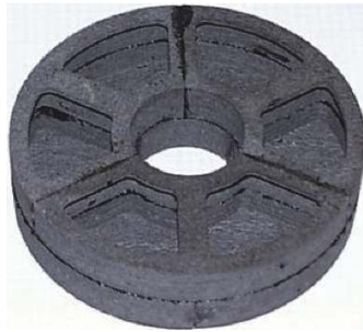
图 2 六部分连接组成的镜坯 [41]
