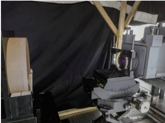
图 9 主镜 CGH 补偿检测光路图
