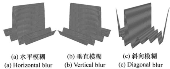
图1 光学传递函数  $\text{OTF}(u,v)$  曲线
