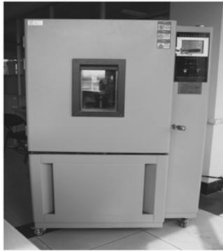
图2 高精度恒温设备
