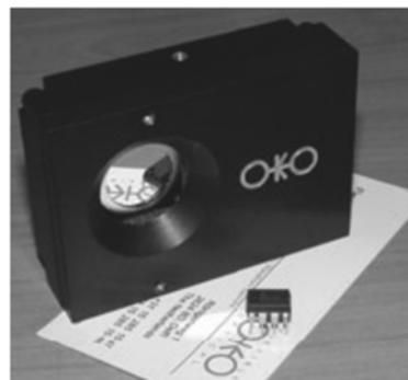
图 15 OKO 的 37 单元薄膜变形镜
