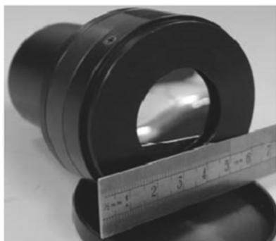
图 17 20 单元双压电片变形镜
