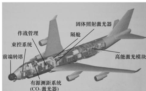
图 2 机载激光系统结构图
