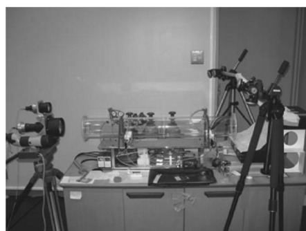
图 15 TANSO-FTS 采用气体池模拟大气吸收过程 [33]
