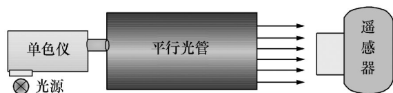
图 6 单色仪光谱定标基本原理图
