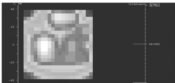
图10 前、后视相机光学系统杂光在像面上的能量分布
