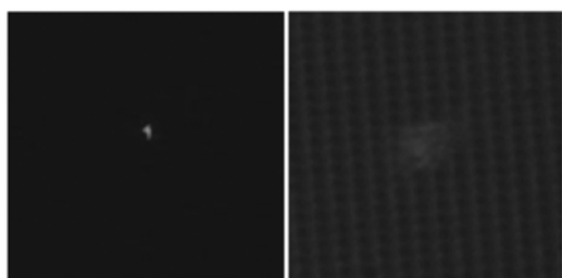
(a) CCD 视频输出图像 (b) CCD 表面损伤情况 (a) Video image of CCD (b) Surface damage of CCD
