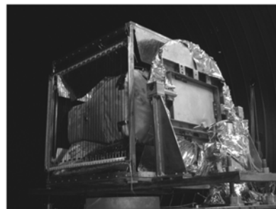
图6 遥感器热平衡试验
