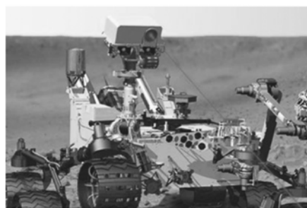
图 7 “好奇号”火星探测车上装载的 LIBS 系统 Fig. 7 LIBS system mounted on the “Curiosity” rover
