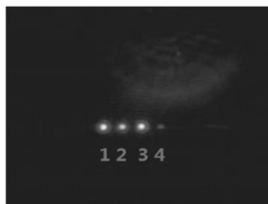
图 10 延迟线红外输出光斑(输入信号光 1 550 nm, 0.25 mW)
