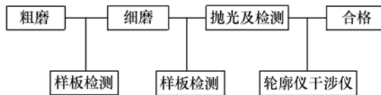
图 12 柱面镜加工过程及检测方法流程图
