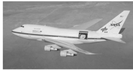
图5 SOFIA 首次打开舱门进行飞行观测
