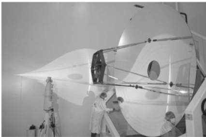
图 8 全部由 SiC 材料制造的 HERSCHEL 空间红外望远镜
