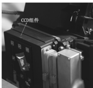
图10 CCD组件装调完成
