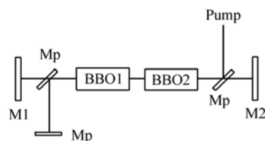
图 1 双波长 BBO-OPO 示意图
