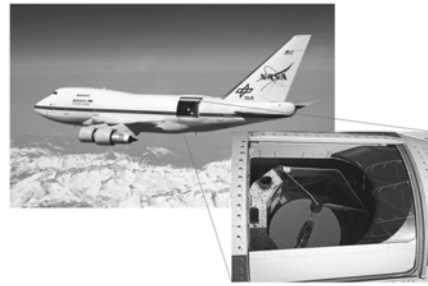
图 14 安装于波音 747 中的 SOFIA
