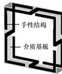
图 7 手性吸波体的结构 Fig. 7 Chiral absorbing materials
