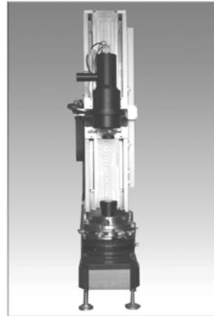
图 12 镜面偏心测量设备
