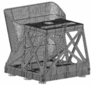
图3 遮光罩与主支撑框架有限元模型
