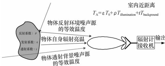
图3 室内被动成像温度模型
