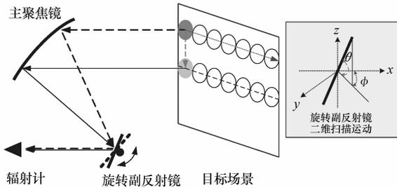
图 5 单辐射计二维扫描示意图
