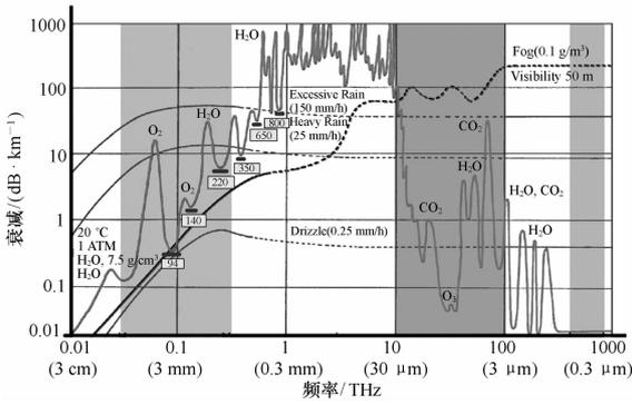
图 2 电磁波辐射衰减曲线
