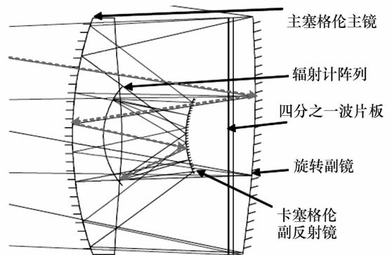
图 8 基于卡塞格伦结构的折叠光路扫描
