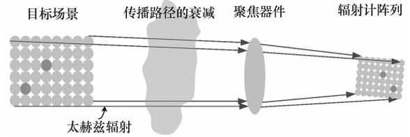
图 6 太赫兹准光学被动成像原理
