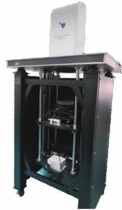
图 12  $\Phi 200\text{ mm}$  口径长焦距球面干涉测试装置
