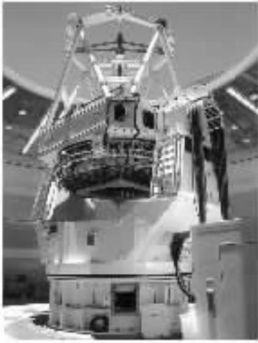
图 5 带 AO 的 3.67 m 口径大型望远镜
