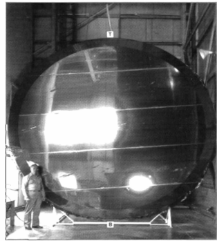
图5 NASA 4.88 m 静电拉伸薄膜反射镜
