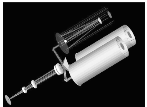
图 16 ARGOS 光学结构 Fig. 16 Optical layout of ARGOS
