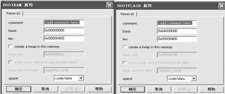
图 3 DSP/BIOS 中的存储器空间配置图
