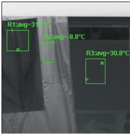
图2 不同表面发射率材料的红外图像
