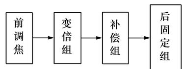
图3 带前调焦的摄像机光学系统框图
