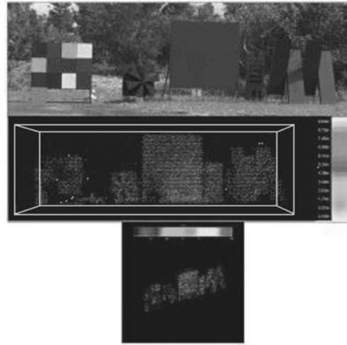
图 12 JIGSAW 系统对距离 150 m 处的各种静态校准目标所成 3D 图像
