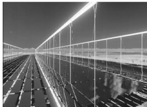
图6 德国 NOVATEC 公司的线性菲涅耳聚光发电系统
