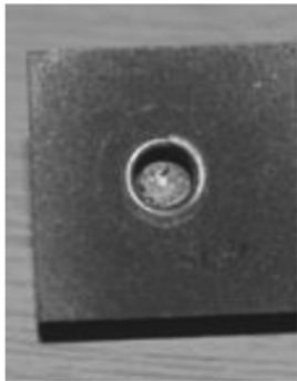
图5 安装钢丝螺套后的样件
