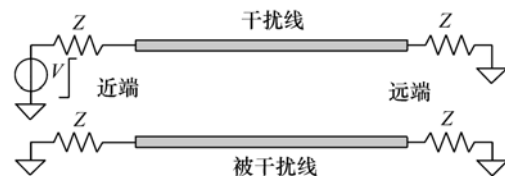
图1 相邻走线的等效传输线模型
