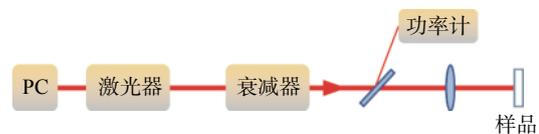
图 3 飞秒激光损伤系统原理图
