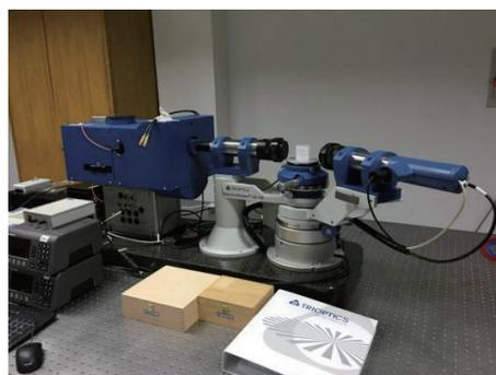
图 6 高精度手动折射率测量仪
