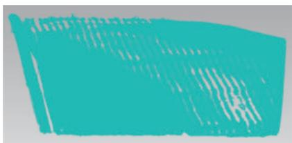
图8 反光形成的点云缺失
