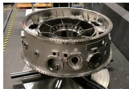
图 16 航天发动机机匣
