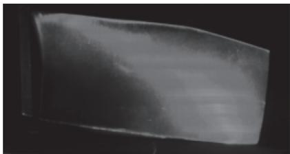
图7 薄壁叶片表面反光现象
