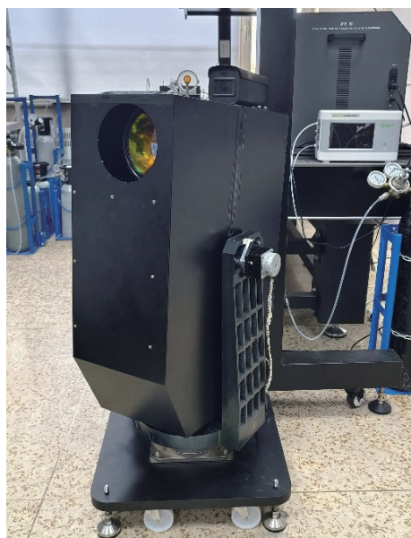
图 11 全景双谱段红外成像干涉光谱测量反演仪器样机 Fig. 11 Prototype of the infrared imaging interference spectrometer
