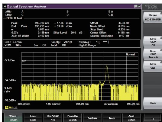
图 7 VCSEL 的输出光谱测试结果
