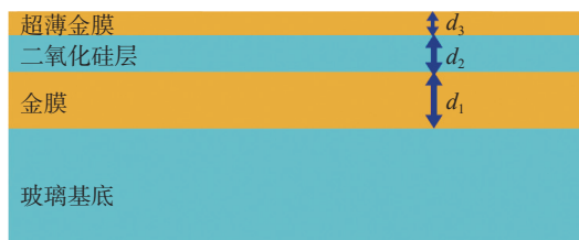
图 1 提出的三层金-氧化硅-金薄膜结构示意图
