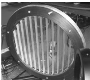
图 6 CZMIL 系统设计加工的圆形菲涅耳透镜实物图
