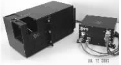
图 7 紫外臭氧垂直探测仪
