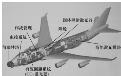
图 2 机载激光系统结构图
