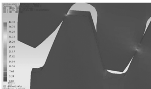
图7 齿面接触应力云图
