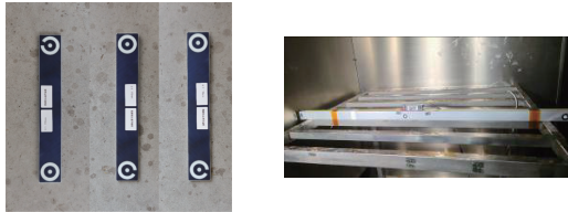
(c) 固定靶标阵列 (d) 实验用光栅尺 (c) Fixed target array (d) Optical linear encoder
