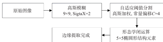
图 1 激光切割挂渣轮廓算法流程图
