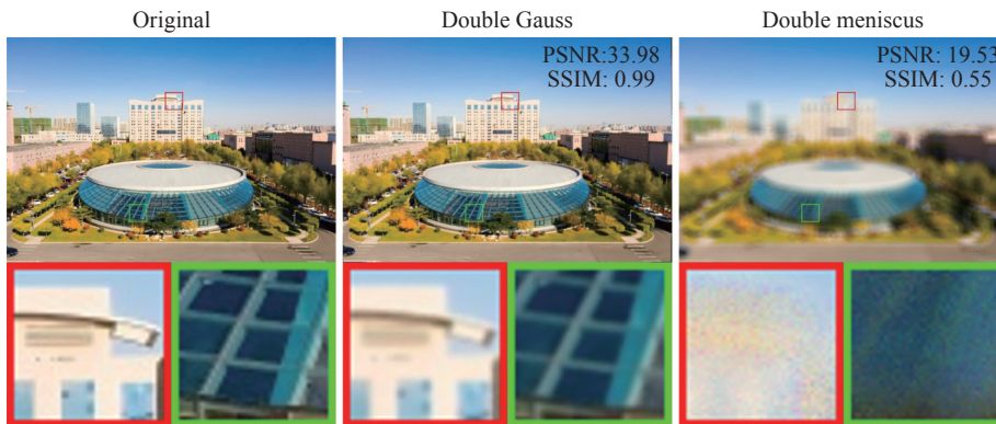
图 8 双高斯光学系统与双弯月光学系统的仿真成像对比
