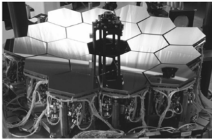
图9 詹姆斯韦伯空间望远镜的拼接镜面主动光学系统
