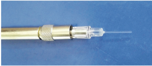
图 3 “Y”型光纤和光纤探针连接示意图
